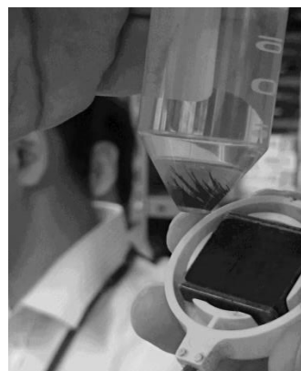
図 6 分離後の Ni ナノ粒子(磁性を有するため、磁石に近づけると針状になっている)
