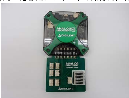
図1 Analog Discovery2 の外観 (Transistor Tester 取り付け後)
