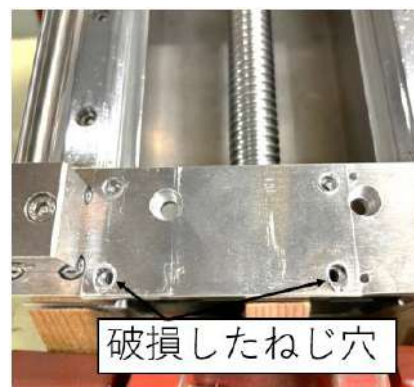
図 2 破損した部品の状態
