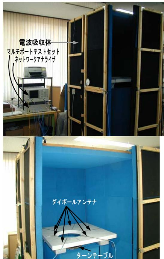
図1 マイクロ波CT測定システム
