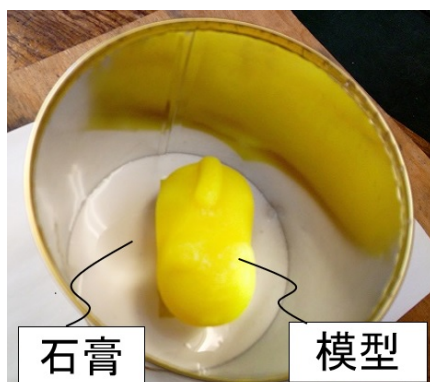
図 4 石膏を 1 回入れた状態
