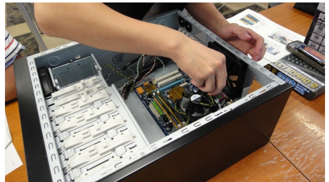
6. マザーボード組み込み中
