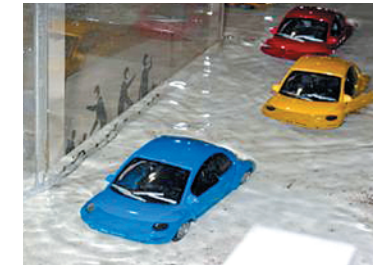
地下駐車場への浸水の様子（模型実験）
