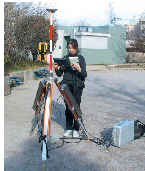
斜面定期健康診断用自動制御三脚とGPS
