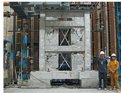
鉄筋コンクリート壁の载荷実験
