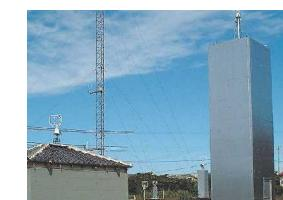
野外に設置した建物模型による風圧力の観測
