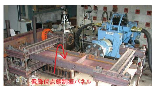
低降伏点鋼制振パネルダンパーの動的繰返し載荷実験
