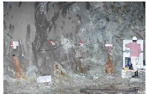
神岡鉱山茂住坑道での間隙水圧測定
