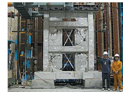
鉄筋コンクリート壁の載荷実験
