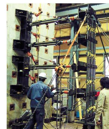
提案耐震補強システムに対して構造試験-数値解析併用型地震応答再現実験手法を適用した例
