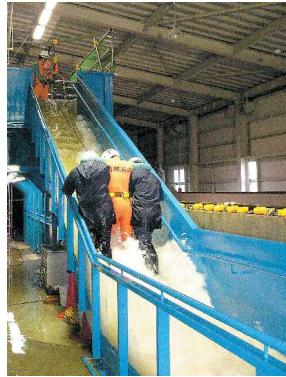
地下浸水時における避難実験のための実物大階段模型
