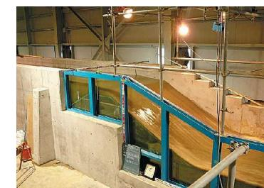
堤防の越流破壊実験
