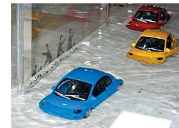
模型・地下駐車場への浸水の様子
