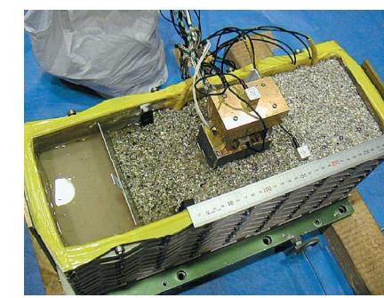
地盤-杭-構造物系の遠心載荷実験
